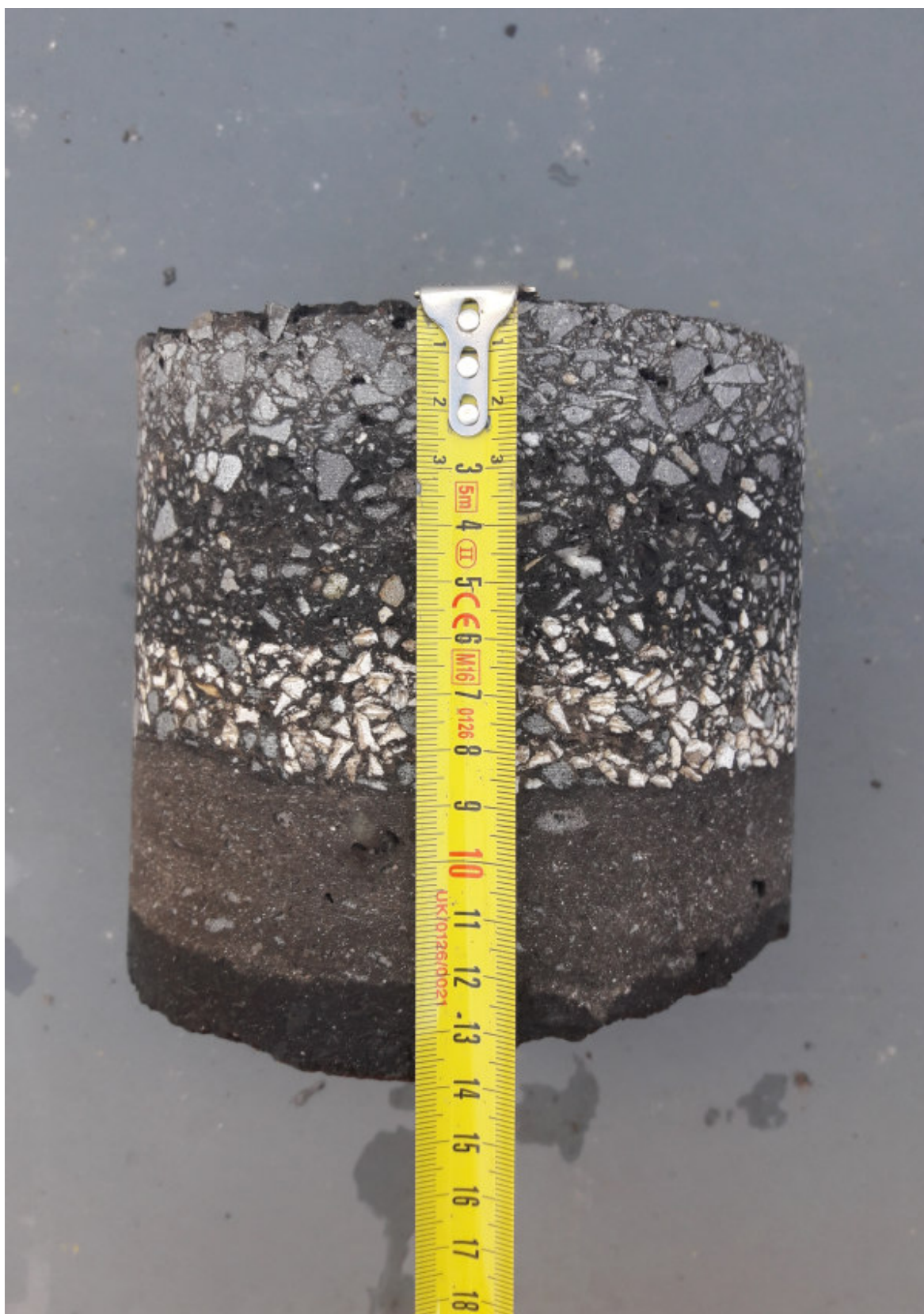
12. kép: Fúrt minta Nyíregyháza, Móricz Zsigmond u. 0+145 km szelvény jobb o. tengelytől 1,90 m-re
