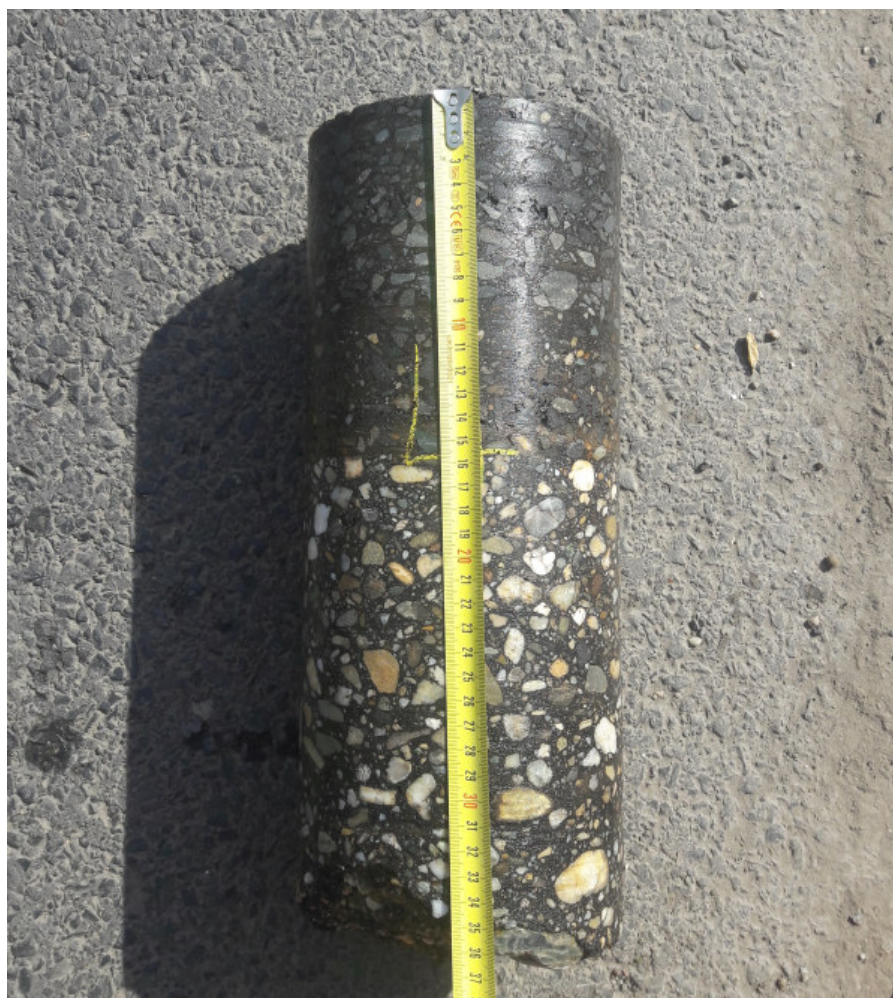
7. kép: Fúrást követően Nyíregyháza, 3317. j. út 55+600 km szelvény bal o. tengelytől 2,80 m-re
