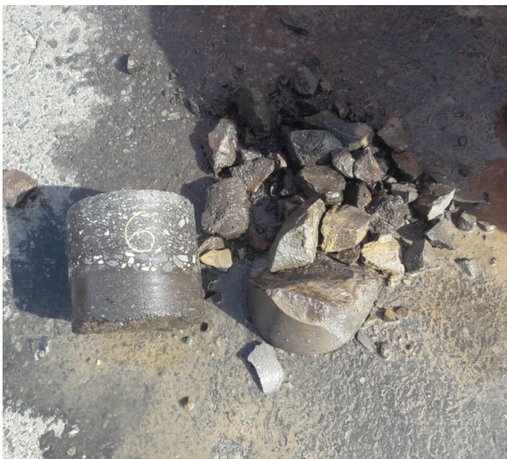
11. kép: Fúrást követően Nyíregyháza, Móricz Zsigmond u. 0+145 km szelvény jobb o. tengelytől 1,90 m-re
