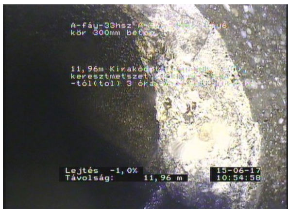
Fáy6_7cb55bfe-399a-41fb-a50a-774edfd82def_20170615_10 5632_929.jpg, 00:04:37, 11.96 Kirakódott anyagok, zsír, 10% keresztmetszet csökkenés 9
