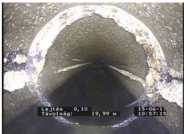
Fáy6_94f005b5-a62a-4455-9ec7-9fca43fd5a1c_20170615_10 5849_370.jpg, 00:06:44, 19.99 Kirakódott anyagok, zsír, 10% keresztmetszet csökkenés 9
