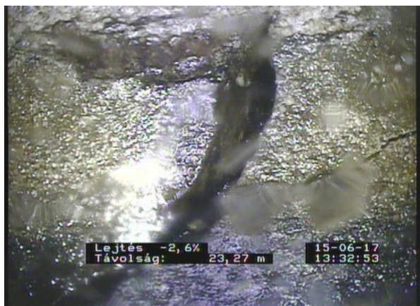
Fáy8_9763607a-46d3-4cb9-a013-f566bde72333_20170615_133427_770.jpg, 00:07:53, 23.27 Csotórés/Beomlás, a cső darabjai láthatóan elcsúsztak, de
