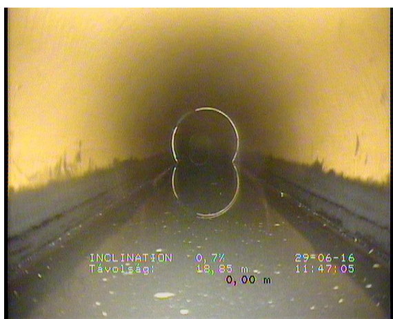
Fek-3sz-Táncsics_71c83294-78e2-452e-9c57-e6c3da89b9b3_20160629_114826_609.jpg, 00:02:00, 18.85 Vízszint, zavaros vagy elszíneződött, 15%, szakaszhiba kezdete #
