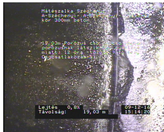
széchenyi2_aaf47d91-fae4-4e9a-8802-79fb2d34895e_20161209_151450_466.jpg, 00:02:53, 19.03 Porózus csó, a csó anyaga porózusnak látszik (pl.gyártási hiba miatt) 12 óra -tól(tol) 11 óra, Csocsatlakozásnál
