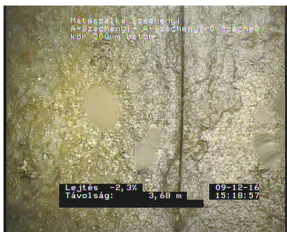
Széchenyi3_1bbddcfb-beb3-40d4-9ee8-a3b84a7f9b1e_20161209_151927_496.jpg, 00:00:48, 3.68 Porózus cso, a cso anyaga porózusnak látszik (pl.gyártási hiba miatt) 12 óra -tól(tol) 11 óra, Csocsatlakozásnál
