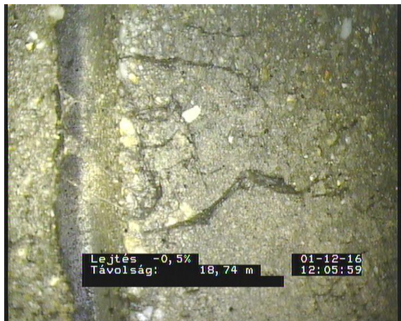
Szent István 3_5dcd8190-2666-4c7c-bdac-b9c962a291b3_20161201_120619_770.jpg, 00:08:47, 18.74 Repedésképződés, felszíni repedés (hajszáltrepedés), hosszirányban, 3mm 10 óra, Csocsatlakozásnál
