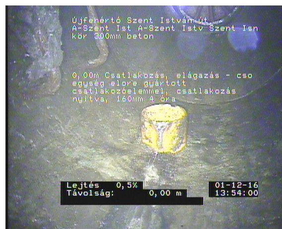
Szent István 5_ea81e9e9-8f05-425f-a0d1-1ed4366914c6_20161201_1354 20_873.jpg, 00:00:37, 0.00 Csatlakozás, elágazás - cso egység előre gyártott csatlakozóelemmel, csatlakozás nyitva, 160mm 4 óra
