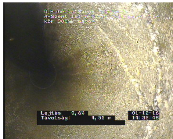
Szent István 8_93c01404-3bf8-423e-bea4-1a46fac7cb7c_20161201_143308_915.jpg, 00:03:03, 4.70 Repedésképződés, a törésvonalak felismerhetők a csőfalán, hosszirányban, 5mm 10 óra, Csocsatlakozásnál
